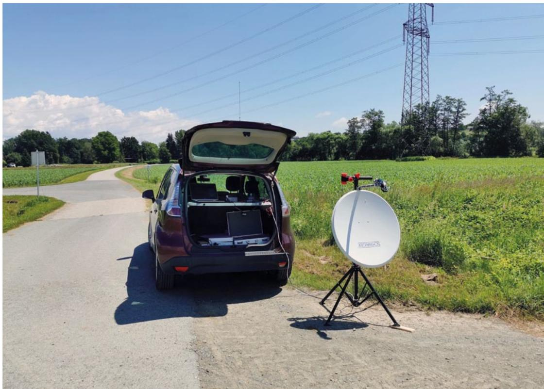
Der 80 cm-Spiegel, der von Robert OE6RKE für alle Bänder von 1–10 GHz verwendet wird. Die Antenne ist über Deutschlandsberg nach OE4 gerichtet.
