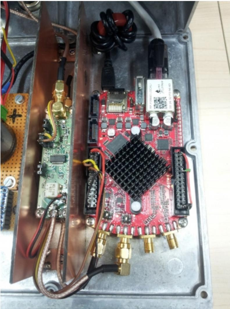
Die Technik besteht aus einem WSPR Multiband-Empfänger auf Basis eines Red Pitaya, der simultan bis zu acht Bänder von 160m bis 6m beobachten und mehrere hundert Empfangsberichte stündlich in das WSPR-Net einspeisen kann. In einigen Tagen ist auch die Inbetriebnahme eines Multiband-Senders mit 5 Watt Ausgangsleistung an einer Procom-Vertikalantenne vorgesehen.
